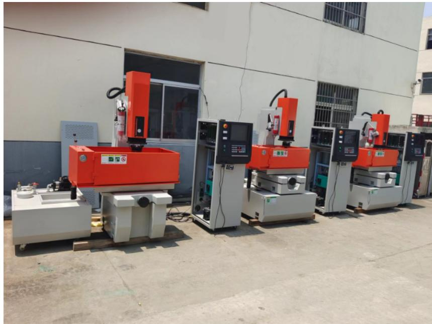
火花机的工作人员可以根据需求设置机器的工作模式及速度，机器内设置了1000个以上的加工条件，可以直接进行选择，降低了使用难度和操作指数，提高了工作效率。此外还有100个以上的存储空间，工作人员可以根据个人的需求保存加工条件，方便以后使用。数控火花机还具有多样简便的摇动加工及多点加工功能，圆形形状加工不只可以做椭圆形形状加工，还可以做多点旋转及多点摇动加工，并且可以做简易模具修正。数控火花机还配备了多样的自检监控功能，不提高了准确度，操作更加简单便捷，机械易于保养和维护。
